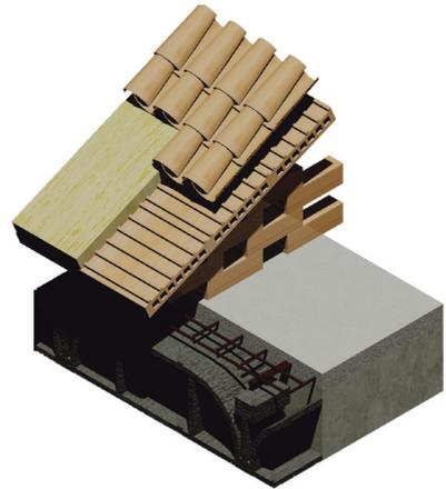
20. Cubierta inclinada con aislamiento por el exterior
