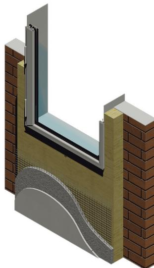
35. Mejora de puentes térmicos en huecos mediante inyección.
