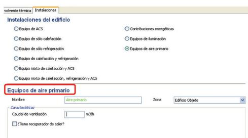
Introducción de caudales de ventilación de algunos equipos en H.U LIDER-CALENER y CE3X
