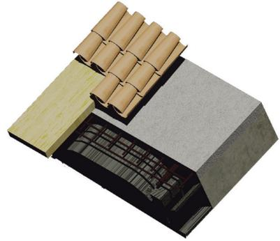
23. Cubierta con forjado inclinado
