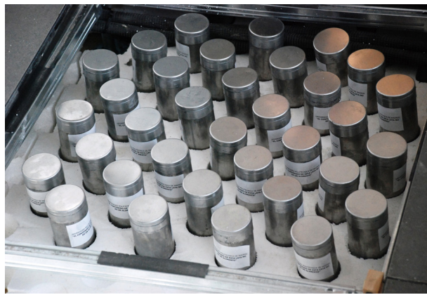
Sistemas de almacenamiento de energía en parafina: Encapsuladas en cilindros metálicos de pequeño tamaño para situarlas en un suelo técnico
