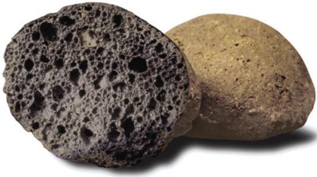
Figura 24 - Estructura interna de arcilla expandida.
