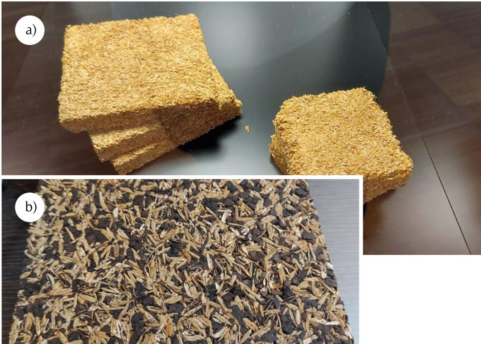
Figura 31 - Placas aislantes de cáscara de arroz a) 100% cáscara de arroz, y b) cáscara de arroz en combinación con regranulado de corcho expandido (prototipos). Fuente: Cortesía Itecons.
