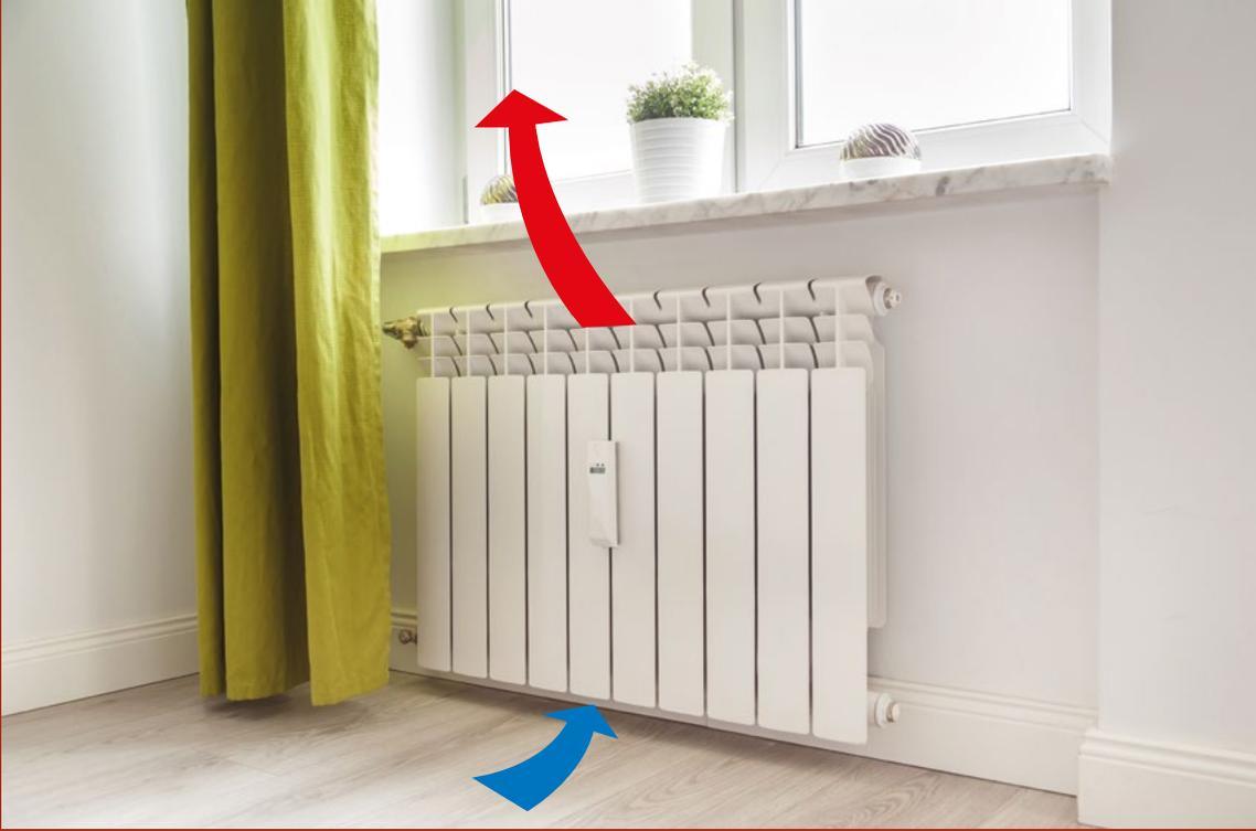
Figura 5 - Corrientes de convección en una habitación calentada por un radiador.
