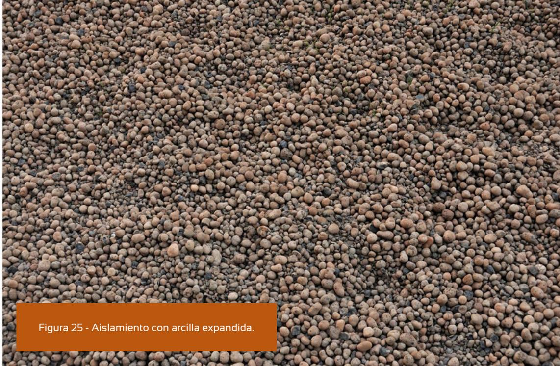
Figura 25 - Aislamiento con arcilla expandida.
