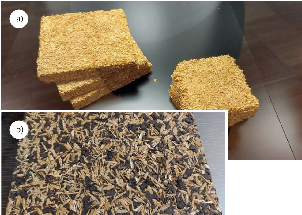
Figura 31 - Placas de isolamento com casca de arroz a) 100 % casca de arroz, e b) casca de arroz em combinação com regranulado de cortiça expandida (protótipos). Fonte: Cortesia Itecons.
