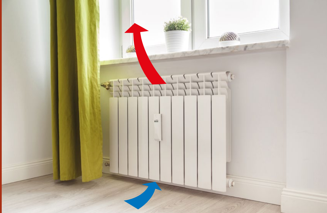
Figura 5 - Correntes de convecção numa sala aquecida por um radiador
