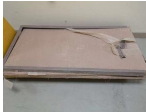
Fig.1: Imágenes de paneles aislantes, en este caso, de fibra vegetal
