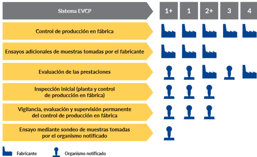
Fig.4: Sistemas de evaluación y verificación de la constancia de las prestaciones (sistemas EVCP)
