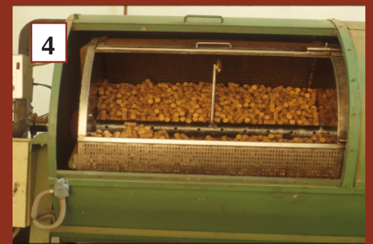
Fabricación tapón natural: 1) Rebaneo; 2) Perforación; 3) Brocas; 4) Secado, ICMC-CICYTEX
