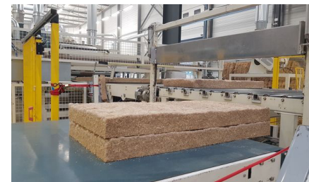
Panel aislante semi-rígido de paja de arroz, FBT Isolation, 2021
