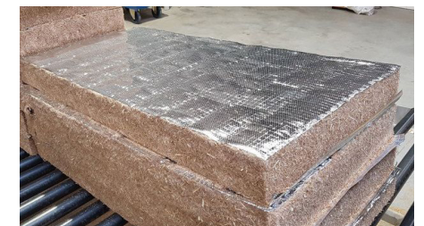
Panel aislante de paja de arroz con placas reflectantes, FBT Isolation, 2021
