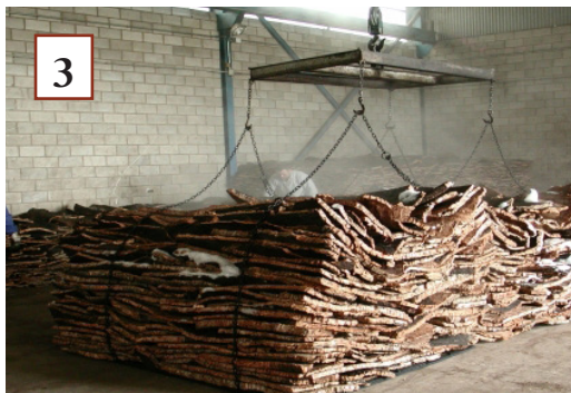
Preparación del corcho en plancha: 1) Reposo en crudo; 2) Cocido del corcho; 3) Reposo en bodega; 4) Retaqueo y escogido, ICMC-CICYTEX
